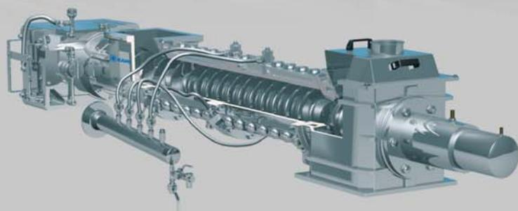
**Кондиционирование под давлением в экспанжере "КАЛЬ" с кольцевым зазором**
