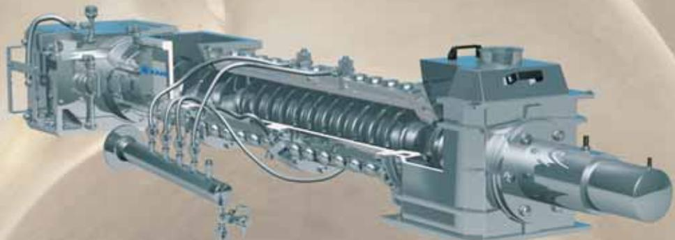
**Кондиционирование под давлением на экспандере с кольцевым зазором**
