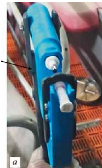
Фото 8. Критерий отбора пробы ДНК: а – пистолет без красного шарика на поршне (см. стрелку), б – пробирка с ушным выщипом
